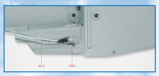
3акрепите электропроводку светодиода на внутренней поверхности щитка ниши левой опоры шасси скобой (Р2О2) и винтом FM, как показано на снимке.
